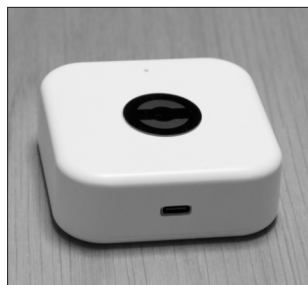
Gateway - connexion pour environ 20 serrures
